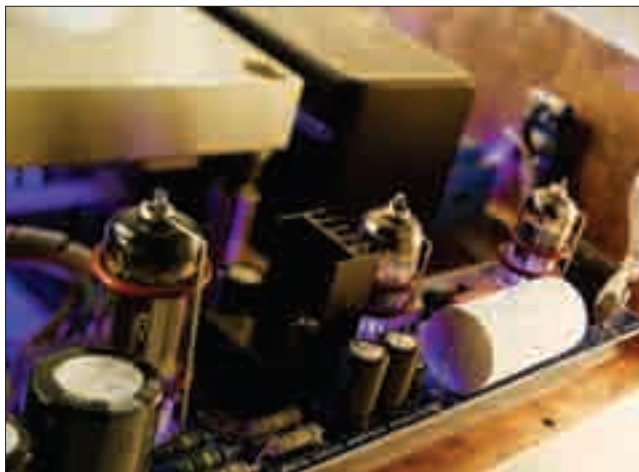
▲ NOS лампы фиксируются зажимами и снабжены резиновыми демпферами
