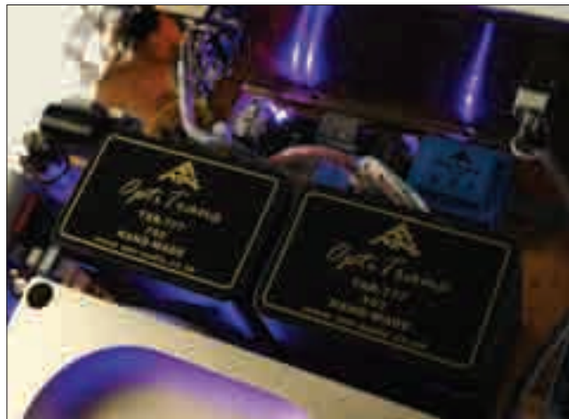
▲ Изготовленные вручную силовые трансформаторы – в герметизированных оболочках
